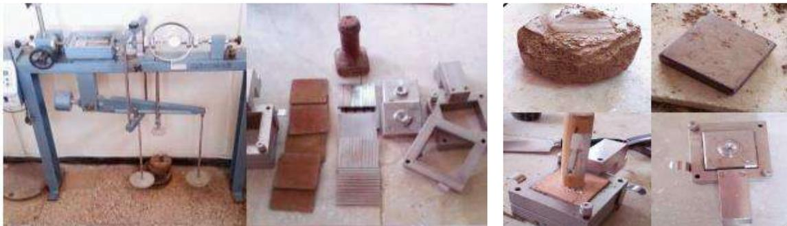
**Figure 4.** Appareillage de cisaillement et préparation de spécimens
