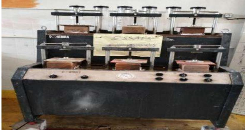
Figure. 1. Appareil de mesure de la perméabilité à l'eau
